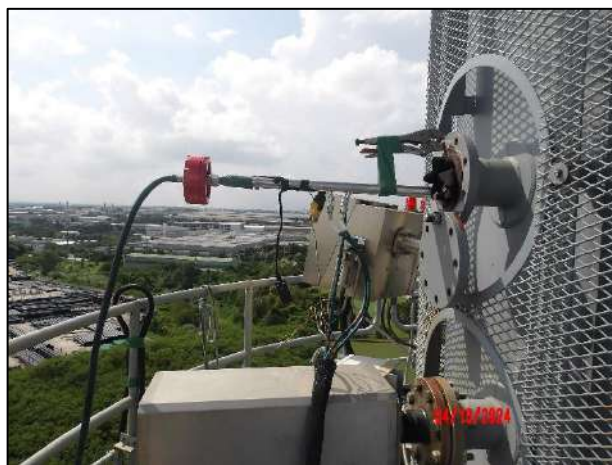
ภาพที่ 4 แสดงการตรวจวัด RM Method ของบริเวณ ปล่องหน่วยผลิตไอน้ำ HRSG# 52
