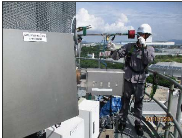
ภาพที่ 2 แสดงการตรวจวัด RM Method ของบริเวณ ปล่องหน่วยผลิตไอน้ำ HRSG# 51
