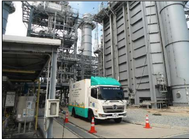
ภาพที่ 1 แสดงการตรวจวัดเพื่อทดสอบความแม่นยำสัมพัทธ์ ระบบ CEMS สำหรับตรวจวัดก๊าซ ของบริเวณ ปล่องหน่วยผลิตไอน้ำ HRSG# 51
