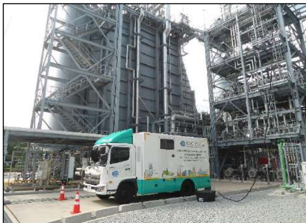
ภาพที่ 3 แสดงการตรวจวัดเพื่อทดสอบความแม่นยำสัมพัทธ์ ระบบ CEMS สำหรับตรวจวัดก๊าซ ของบริเวณ ปล่องหน่วยผลิตไอน้ำ HRSG# 52
